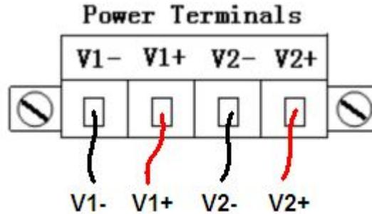
步骤 1:将直流电源DC的正负2端接在V-/V+ 端上。
